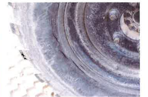
⑥タイヤ亀裂
