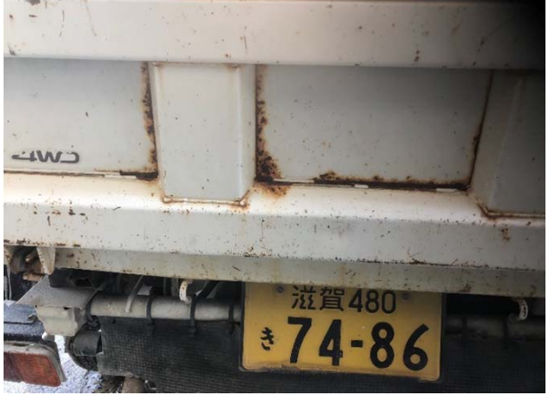
○運転席 リヤあおり 腐食激しい
