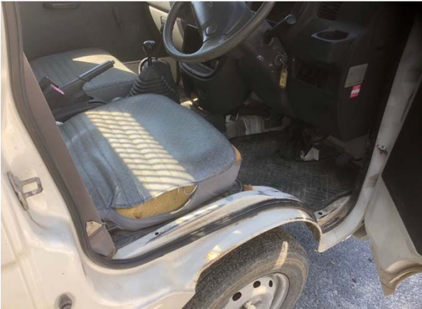
○キャビン内部 シートめくれ
