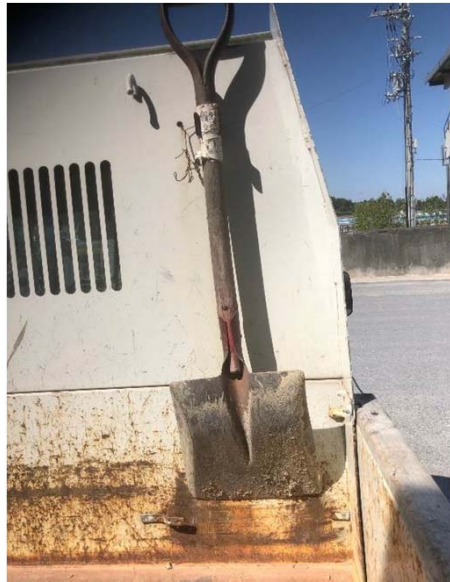
○スコップ掛け 腐食によるはずれ
