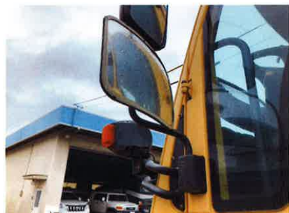
○サイドミラー、劣化 取り付け部プラスチックひび割れ
