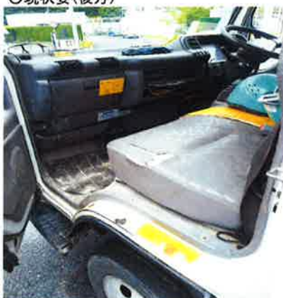
○キャビン内部 シートめくれ
