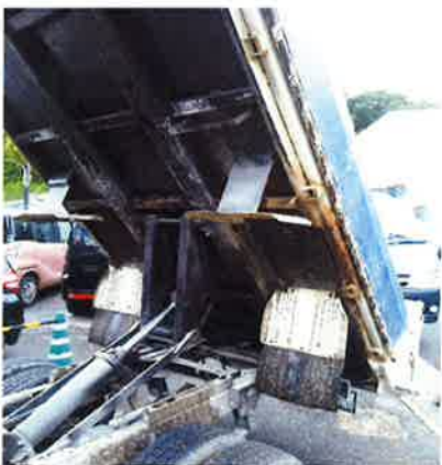
○架装部 一部腐食あり
