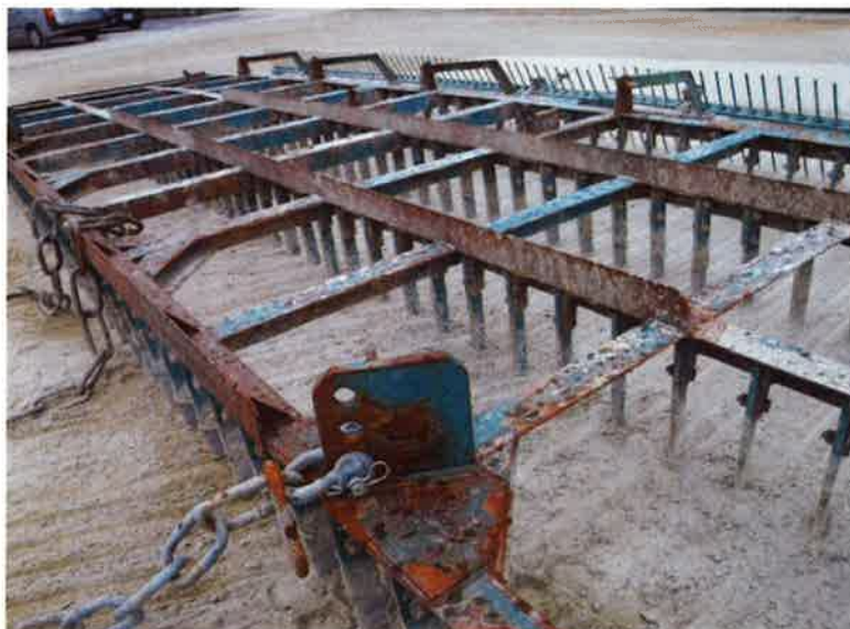
○フレーム拡大 腐食著しい
