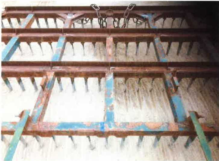
○フレーム拡大 腐食著しい
