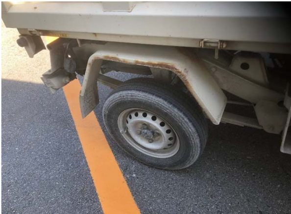
○左後ろフェンダー 腐食著しい
