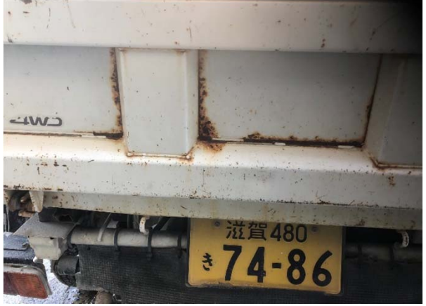
○運転席 リヤあおり 腐食激しい
