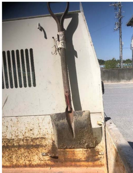
○スコップ掛け 腐食によるはずれ
