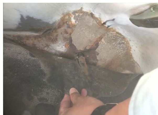
○運転席 足元腐食による穴あき
