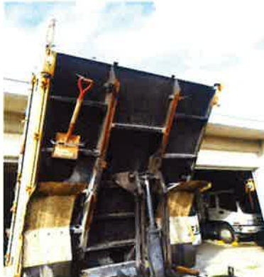
○架装部 一部腐食あり
