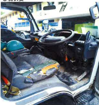
○キャビン内部 シートめくれ
