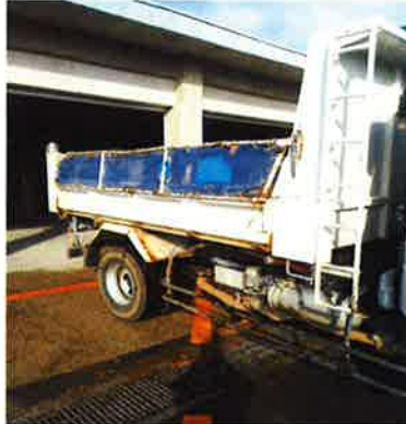
○架装部 一部腐食あり
