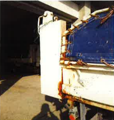
○架装部 一部腐食あり
