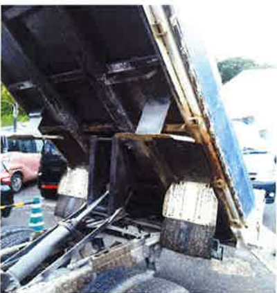
○架装部 一部腐食あり
