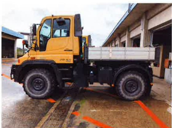
○現状姿 側面 シャーシ各所腐食進む
