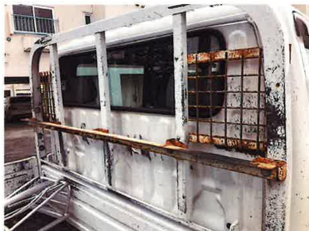
○キャビン後ろ状況 各所腐食進む
