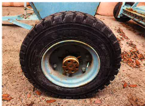
○タイヤ軸部腐食状況
