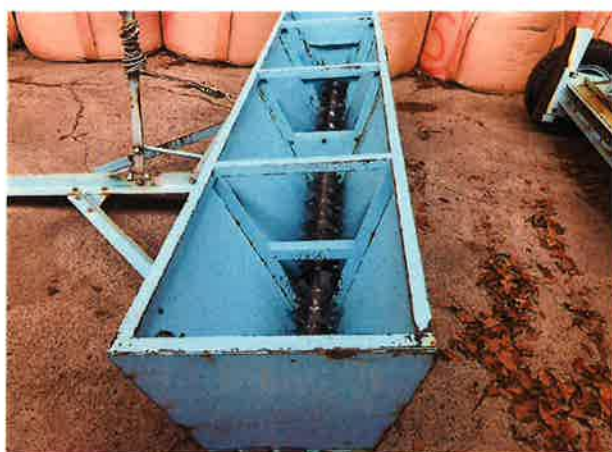
○ホッパー内部状況
