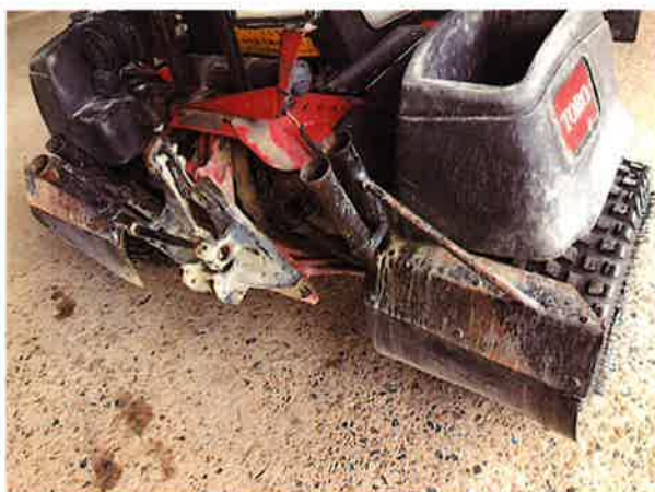
○右後ろフェンダー 歪みあり
