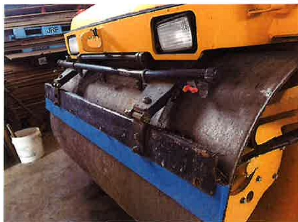
○泥落とし板、変形
