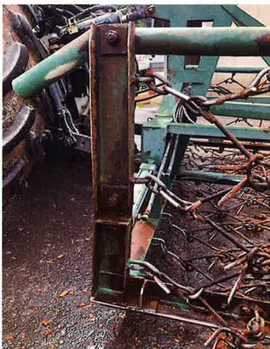
○フレーム拡大 腐食著しい。フレームにひずみ有り。
